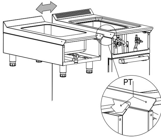
3. Acerque los aparatos y nivéelos girando las patas hasta que las partes superiores coincidan.
