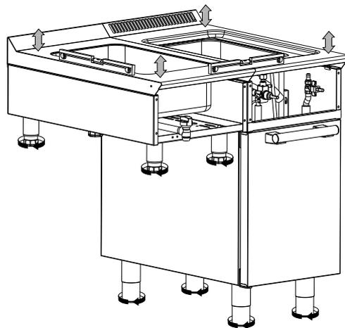
4. Desde el interior del panel de control de los aparatos, únalos en la parte delantera apretando un tornillo de cabeza hexagonal M5x40 con la tuerca (suministrada).
